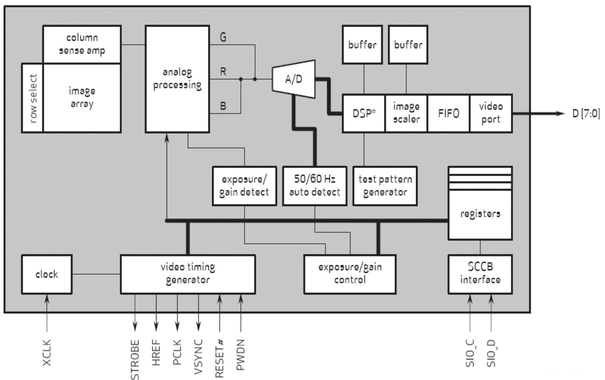
**Note1:** DSP\*(镜头校正、去噪声、黑白点补偿、自动白平衡等)
