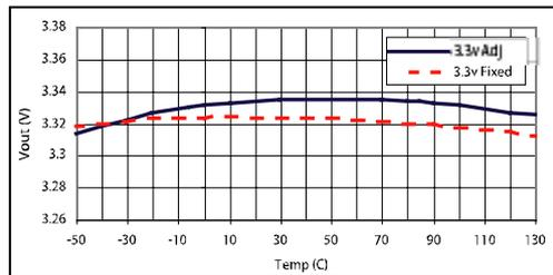
图 12 VIN=5.0V, IOUT=10mA
