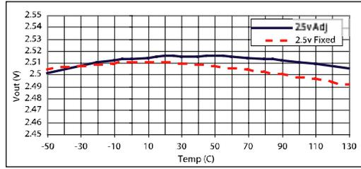
图 9 VIN=4.0V, IOUT=10mA
