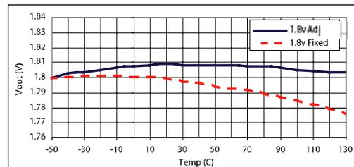
图 8  $V_{IN}=3.3V$ ,  $I_{OUT}=10mA$
