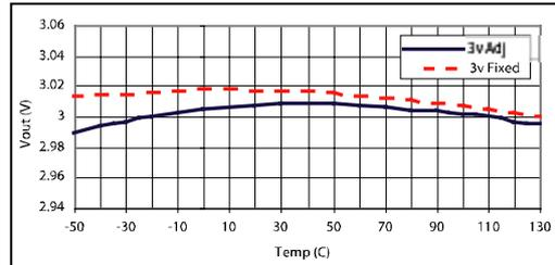
图 11 VIN=4.85V, IOUT=10mA
