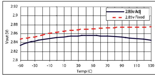
图 10 VIN=4.85V, IOUT=10mA
