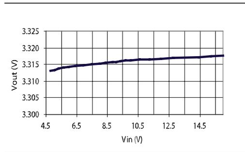
图 2 SPX1117M3-3.3 线性调节率;  $I_{OUT}=10mA$
