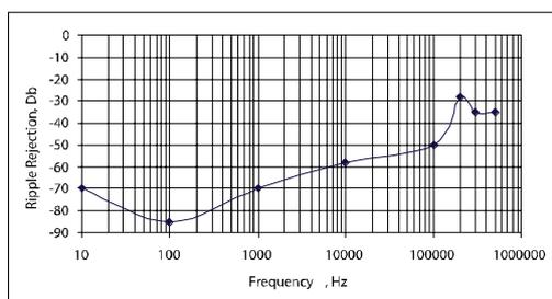
图 20 纹波抑制比； $V_{in}=3.3V$ ,  $V_{out}=1.8V$  (adj.),  $I_{load}=200mA$
