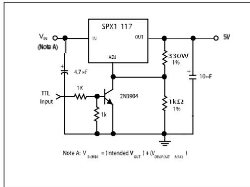
图 24 带关断电路的 5V 调节器
