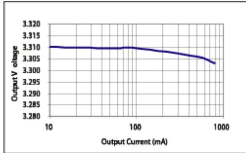
图 1 SPX1117M3-3.3 负载调节率;  $V_{IN}=4.8V$
