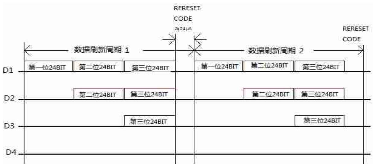
注: 其中 D1 为 MCU 端发送的数据, D2、D3、D4 为级联电路自动整形转发的数据。
